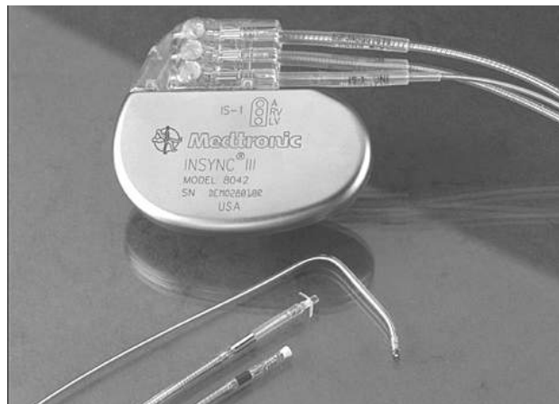
Slika 5. Izgled CRT elektrostimulatora i elektroda Fig. 5. CRT electrostimulator and electrodes
