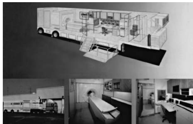
Slika 6. Marijina ideja o „radiološkim kolima” oživela je. Na slici je prikazan mobilni magnetnorezonantni (MR) aparat - 5 Tesla. Šematski je prikazana prikolica. Slikovito su prikazani kamion sa prikolicom, sken soba i komandna soba.
