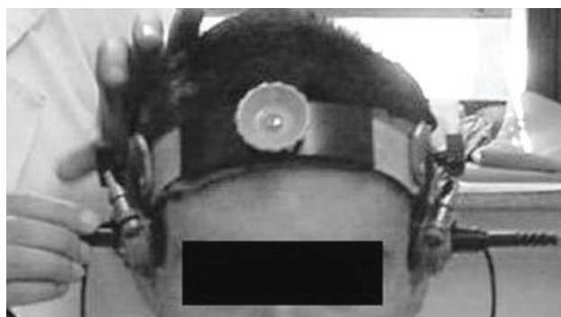
Fig. 1. Headframe used to secure ultrasound probes Slika 1. Ram (šlem) za fiksiranje ultrazvučnih sondi
